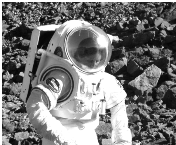
Essai d'un scaphandre prototype de Hamilton Sundstrand dans le cratère Haughton, à Devon Island. La partie « bulle pressurisée » d'un scaphandre à contre-pression mécanique pourrait être limitée, comme ici la partie rigide, à la tête et au torse. (doc. TMS)
