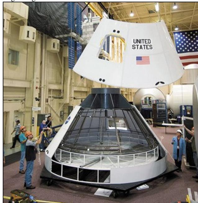
*maquette de la capsule Orion en cours d'assemblage* (doc. NASA)
