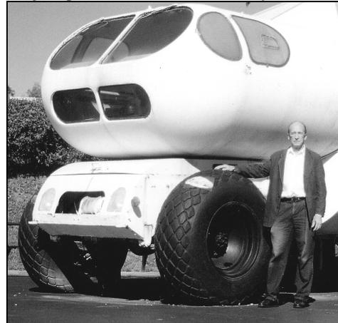
Le rover maintenant à Huntsville. La configuration à pneus n'est valable que pour un démonstrateur terrestre. Un matériau à base de caoutchouc n'accepterait pas les températures extrêmes. (doc. A. Souchier)
