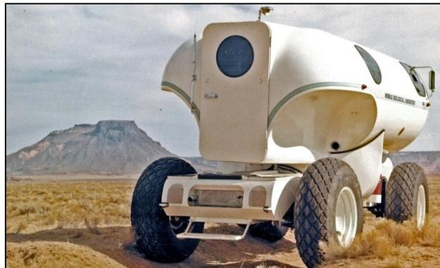
*Le démonstrateur de MOLAB devant Hopi Butte en 1967. Le caisson qui comporte les roues arrière est lié au reste de la structure par un axe horizontal ; il peut donc pivoter en roulis, ce qui assure un contact permanent avec le sol malgré les inégalités du terrain. Les roues pouvant remonter très haut, l'habitacle comporte deux dégagements importants sur les côtés à l'arrière. (doc. USGS)*
