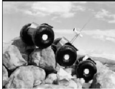
Dans les années 60 General Motors avait également réalisé un prototype à 6 roues. Comme il ne comportait pas le reste du rover, son poids terrestre était égal au poids lunaire d'un rover complet. (D.R.)
