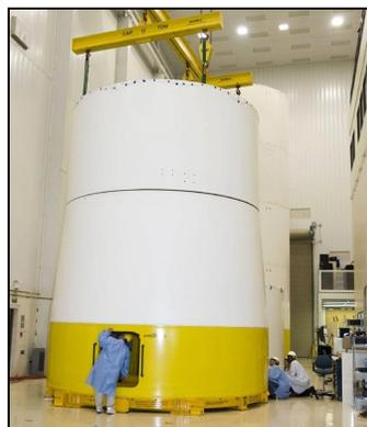
*les exemplaires pour vol Ares IX de la jupe avant et de l'adaptateur qui supportent Orion et le module de service*
