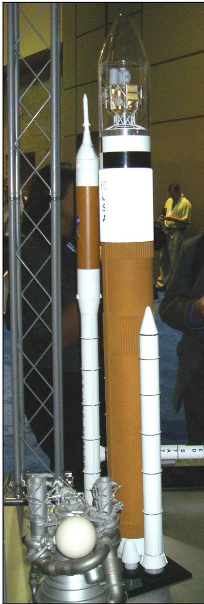
**Ares I en coupe, à gauche, montrant le premier étage à ergols solides et l'étage à oxygène (vert) et hydrogène (rouge) au-dessus. A droite, Ares 5 et Ares 1 ; le lanceur lourd est à peine plus haut. Une hauteur limite de 110 m est imposée par les portes du bâtiment d'intégration VAB, construit à l'époque Apollo. (doc. A.Souchier)**
