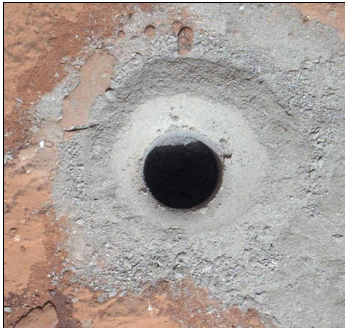
Le premier forage de Curiosity (diamètre : 1,6 cm). La poudre grise produite dénote la présence de fer moins oxydé à l'intérieur de la roche (peut-être sous forme de magnétite).
