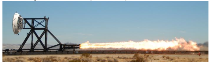
Essai de bouclier sur le chariot d'accélération US Navy. (doc. NASA)
