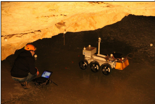
Le rover Magma, de la Mars Society polonaise, transportant les antennes du radar Wisdom. Les petites sphères blanches permettent de restituer le décor et le trajet du rover en 3D.
