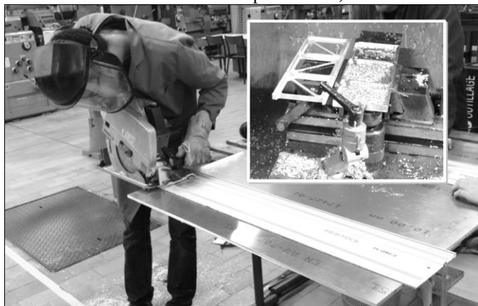
Maquette BIRDY en vue de tests d'assemblage et de vibration en avril 2015. Usinage à partir d'une tôle de 1 cm d'épaisseur jusqu'aux machines à commande numérique. Photo par Équipe Centrale Lille (Edouard Colin, Jordan Diby sur la photo, Juliette Foissaud, Nicolas Heim, Robin Klajzyngier, Tristan Mallet, Lucas Orsatto). (doc. OBSPM/NCKU)
