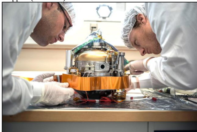
Maquette du sismomètre SEIS, fourni par la France. (doc. CNES)
