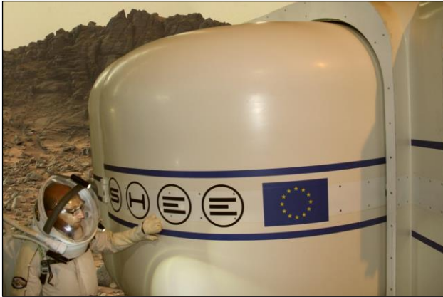
Le prototype SHEE d'habitat planétaire à secteurs déployables et le scaphandre de simulation APM. (doc. A. Souchier/NASA)
