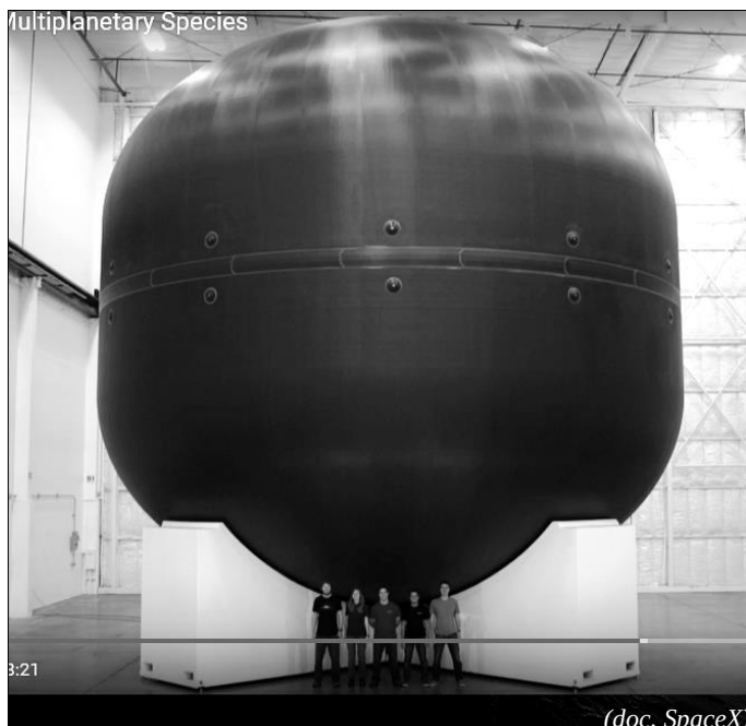
Prouesse technique et première mondiale : l'immense réservoir d'oxygène liquide de la navette réalisé en fibre de carbone.
