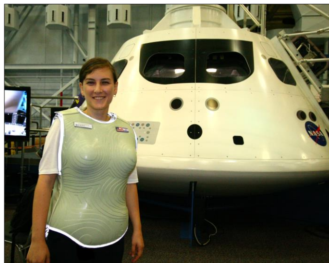
Prototype de veste AstroRad présenté au congrès IAC, avec protection renforcée des zones les plus critiques.
