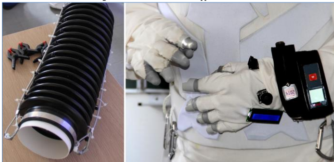
A gauche un soufflet de coude équipé de tirettes guidées pour ne pas s'allonger ou se mettre en zigzag sous l'effet de la pression. A droite les gants et équipements de poignet.
