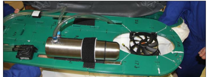
Le système de réfrigération et ventilation est en place dans l'épaisseur de la porte, mais pas encore la bouteille d'air. (docs. A. Souchier)
