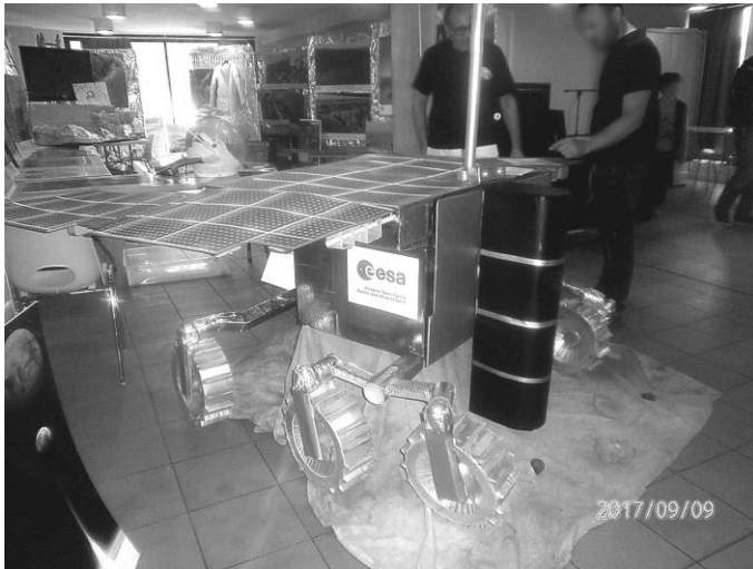
Maquette échelle 1 du rover ExoMars, réalisée par Armande Zamora et Patrick Sibon. Les instruments proviennent d'Europe, mais aussi de Russie et des USA. Fait essentiel, ExoMars pourra forer jusqu'à 2 m, où les conditions de surface ne devraient pas avoir détruit d'éventuelles molécules d'origine biologique. (doc.A.Zamora)
