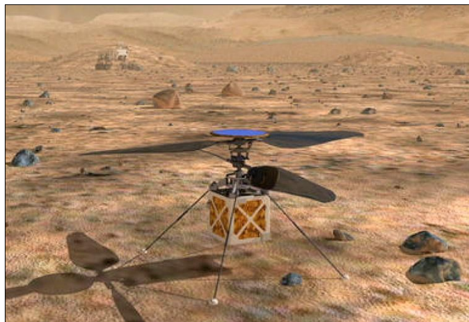
Le mini-hélicoptère de Mars-2020 est représenté ici posé sur le sol martien, après un vol. Son panneau solaire recharge sa batterie.
