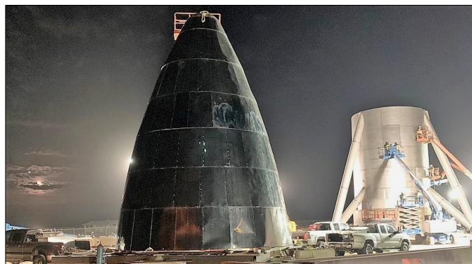
Deux sous-ensembles en inox du prototype du Starship destiné aux essais « hopper », photographiés au port de Los Angeles. (DR)
