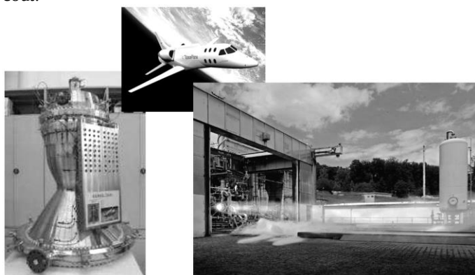
La chambre de combustion du moteur LOx-Méthane du SpacePlane d'Airbus et un des essais à Lampoldshausen. (doc. DLR)
