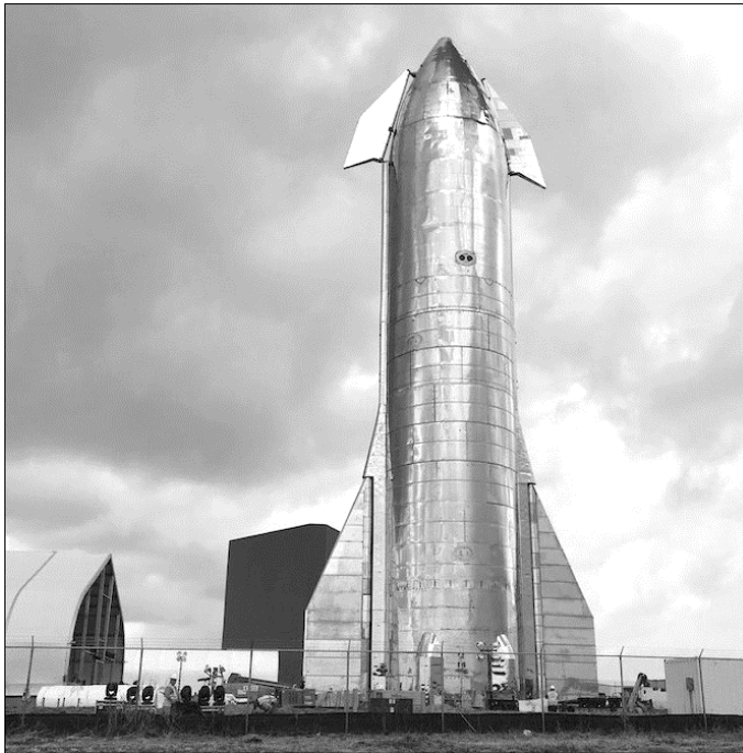
Cette vue montre bien les charnières longitudinales des voilures.
