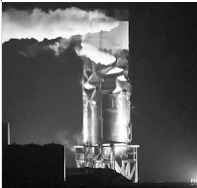
SN3 : superbe faciès de flambage en polygones. (Bocachicagal)
