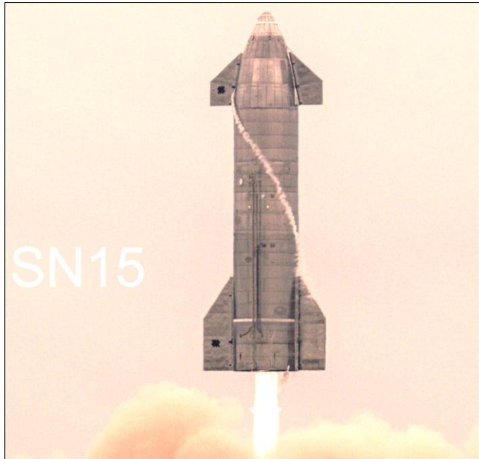
Porté par ses 3 Raptor, le Starship prototype SN15 quitte son pas de tir pour un vol parfait qui marque une étape décisive du programme. (doc.SpaceX)
