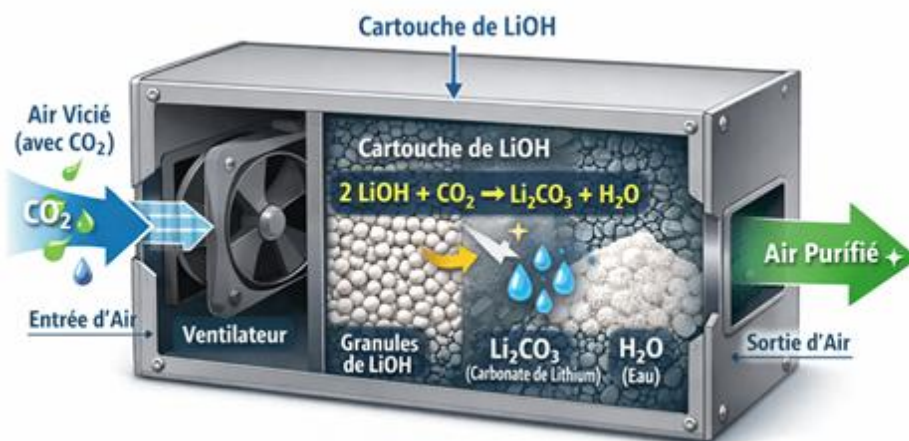
Figure 2 : Système de filtrage du \text{CO}_2 à base de \text{LiOH}
