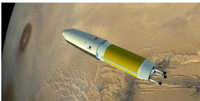
*fusée à moteur thermique nucléaire (NTR) permettant un voyage rapide vers Mars (doc. NASA, montage M. Salotti)*
