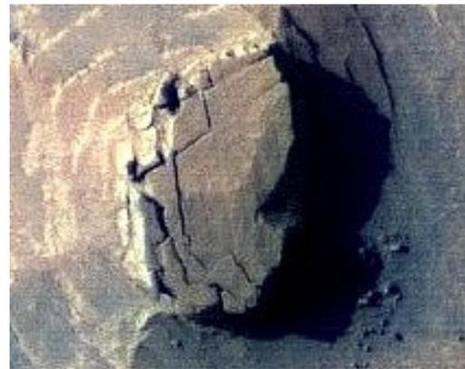
Ci-dessus la mesa est montrée en limite de résolution ; la principale faille qui zigzague à son sommet mesure deux pixels de large soit 60 cm. La hauteur de la mesa est de 12 m. Les bords en haut et en bas de l'ombre, quasi parallèles, montrent que les parois sont pratiquement verticales. Une mesure plus précise donne 85 degrés. (doc. NASA/JPL/UofA)
