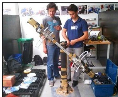
**Heure H pour l'expérience préparée par une équipe de Centrale Lille, soutenue par Planète Mars, visant à démontrer la création d'une gravité artificielle lors d'un vol Terre-Mars par mise en rotation de l'habitat. Le vol sur l'Airbus Zéro G était prévu le 9 octobre.**
