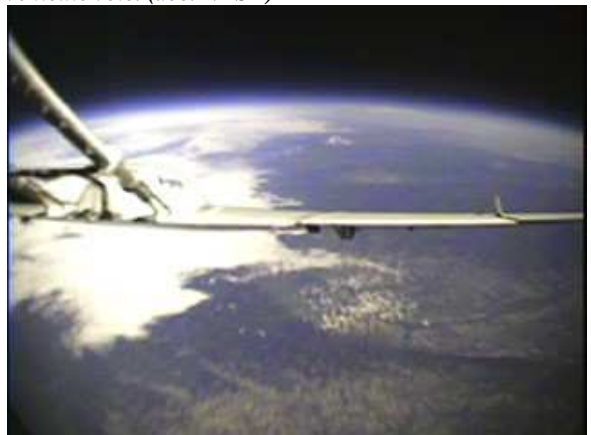
Images réelles prises lors de l'essai de largage de la maquette un demi à 31,5 km d'altitude le 19 septembre 2002. Ci dessus l'aile droite se déploie. Ci dessous le véhicule vole. (doc. NASA)
