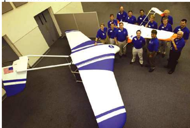
Au premier plan le véhicule ARES du Langley à l'échelle 1. Au fond à droite le véhicule à échelle un demi qui a été essayé en vol, largué depuis un ballon.(doc. NASA)
