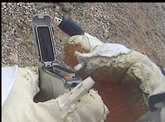
Test des différents dispositifs d'aide à la dextérité sur les gants. Démonstration sur changements de cartes et batteries d'appareil photos. Evaluation type Delta ÖWF de l'écart de durée pour ces opérations/ opérations hors simulation
