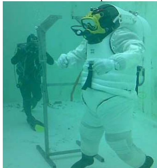
Essais en plongée bassin ; le manchon du gant est resté bloqué dans la manche.
