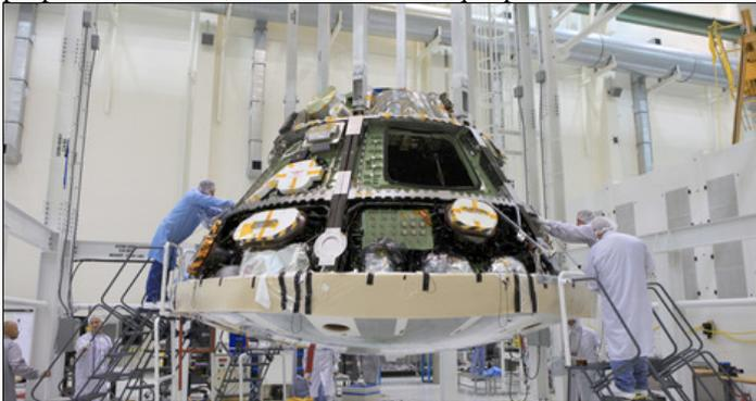
La cabine Orion du premier vol dans son état d'assemblage de juin 2014. Cette partie a une masse de 8,5 t, alors que l'ensemble avec le module de service en configuration opérationnelle aura une masse de 23 t. (doc. NASA)
