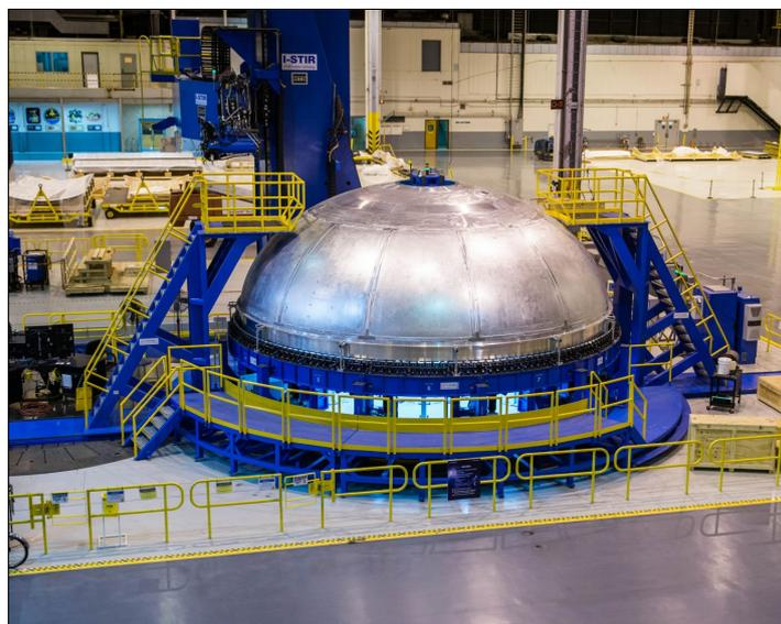
*Un dôme de réservoir du corps central du SLS. Ces éléments mesurent 8,4 m de diamètre et sont produits dans l'usine Michoud de la Nouvelle-Orléans qui produisait antérieurement les réservoirs de la navette, de mêmes dimensions. C'est Boeing qui est en charge du développement et de la production du corps central.* *(doc. NASA)*
