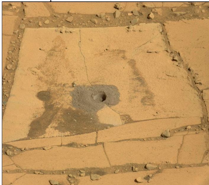
Forage de Curiosity (« Confidence Hills ») dans la couche de roches hydratées sous-jacente au Mont Sharp. (doc. NASA/JPL-CalTech)
