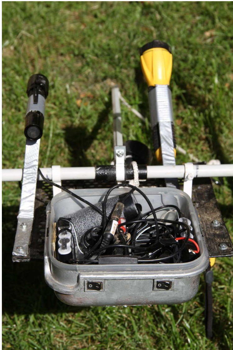
Le boîtier d'émission vidéo sans son couvercle vu du côté des deux interrupteurs
