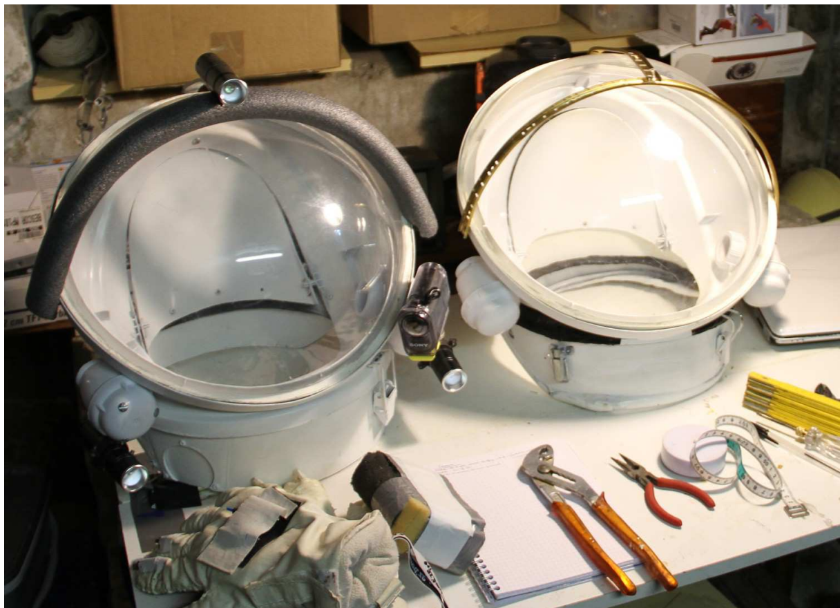
La structure des arceaux de protection du casque 1 avant mise en place des protections extérieures
