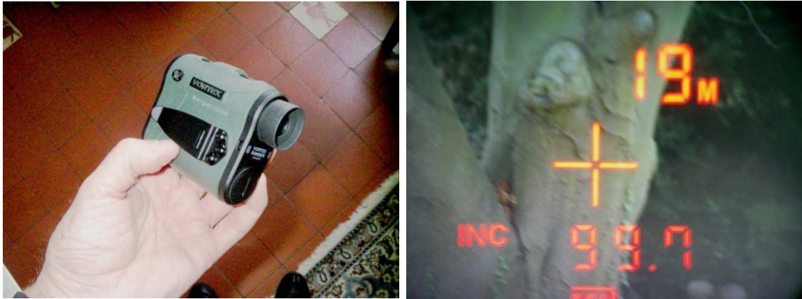
Le télémètre laser Vortex et les indications dans le viseur ; mais ce télémètre ne descend pas en dessous de 10 m en distance de mesure.
