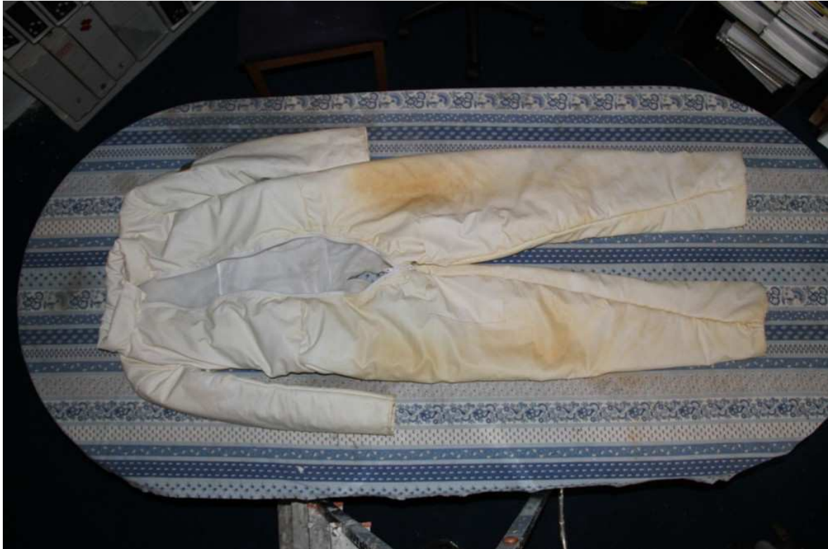
Combinaison femme coté face (et après la simulation). La fermeture sur le devant est une fermeture éclair. Le col dispose d'une fermeture Velcro.
