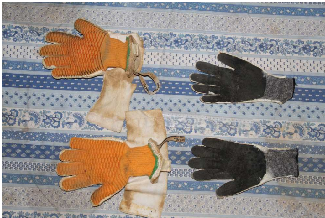
Vue des deux paires de gant coté paume. Sur les gants de gauche la bande qui permet de serrer le gant autour de la manche de la combinaison est en position ouverte. Cette vue est prise après la simulation.
