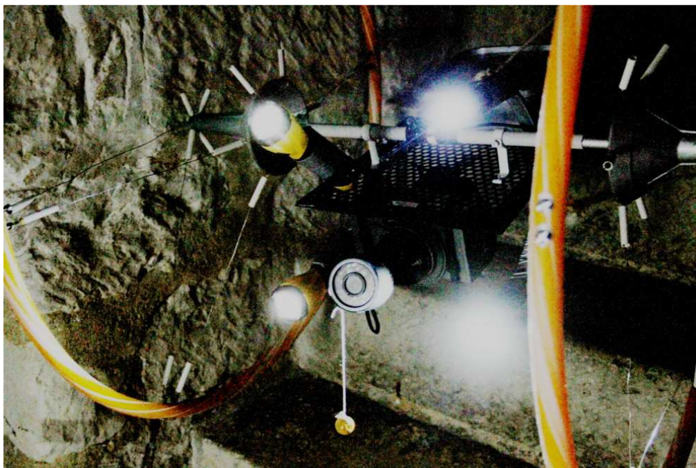
Au centre la caméra montée sur le support Bescor qui balaye automatiquement + ou - 170° est maintenant équipée d'un fil qui indique la verticale dans le champ de vision
