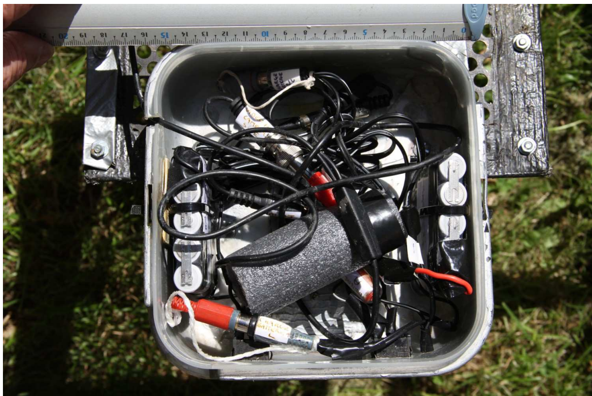
L'intérieur du boîtier d'émission avec les batteries en position latérale. L'émetteur est protégé dans un manchon de mousse. Les interrupteurs sont sur la face en bas de l'image.
