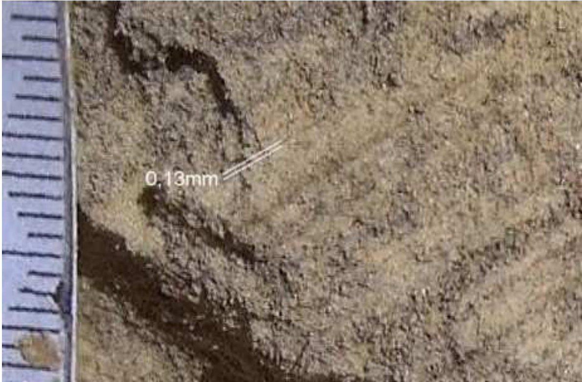
Détail de la vue précédente montrant l'une des plus petites strates que l'on puisse mesurer (caméra Sony HDR GW 55, Alain en sim)
