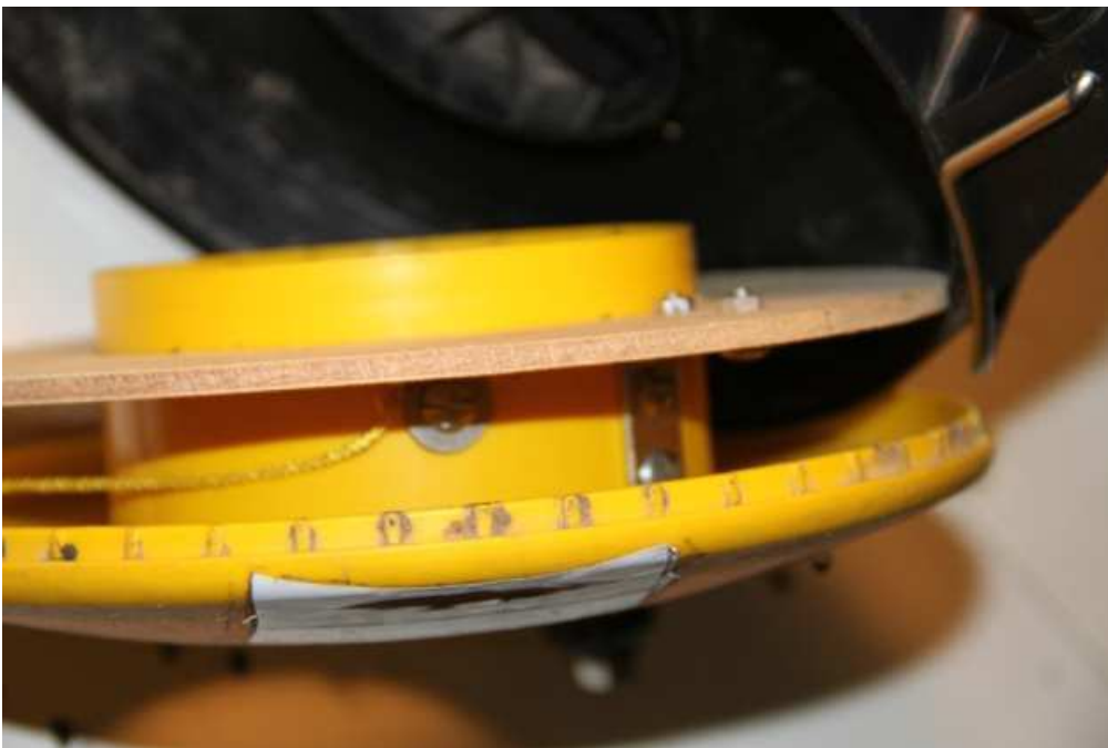
Un flasque a été rajouté dans le dérouleur pour éviter les blocages de déroulement
