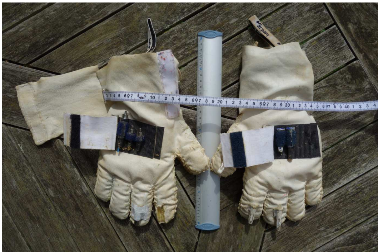
Les gants vus avec les rabats des zones de stockage des aides à la dextérité sur le dessus de la main ouvert. Le rabat tient fermé par du Velcro et les aides à la dextérité sont également tenus par du Velcro.
