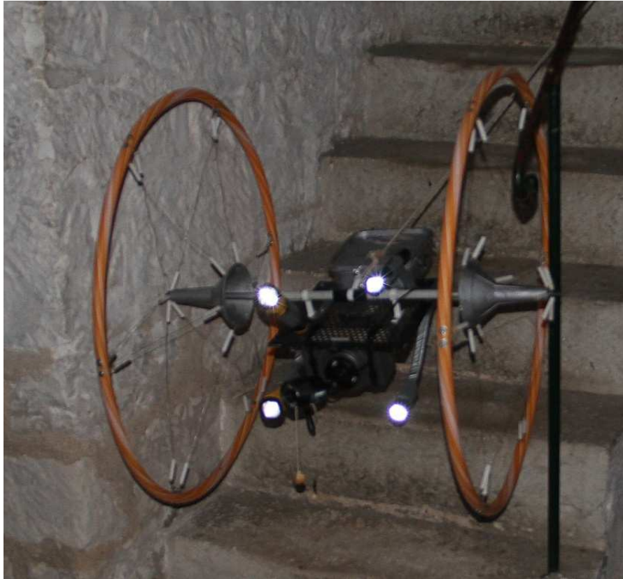
Pour la simulation Petites Dales, le VRP est équipé de 4 lampes
