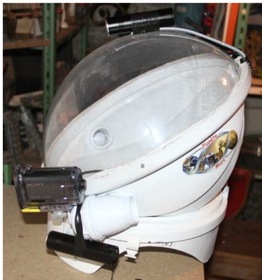
Le casque 2 de profil coté caméra. On voit en bas aussi le petit collier de fixation sur les barres anti roulis. Sur le casque 2 le collier à fermeture est à gauche ; il est à droite sur le casque 1.
