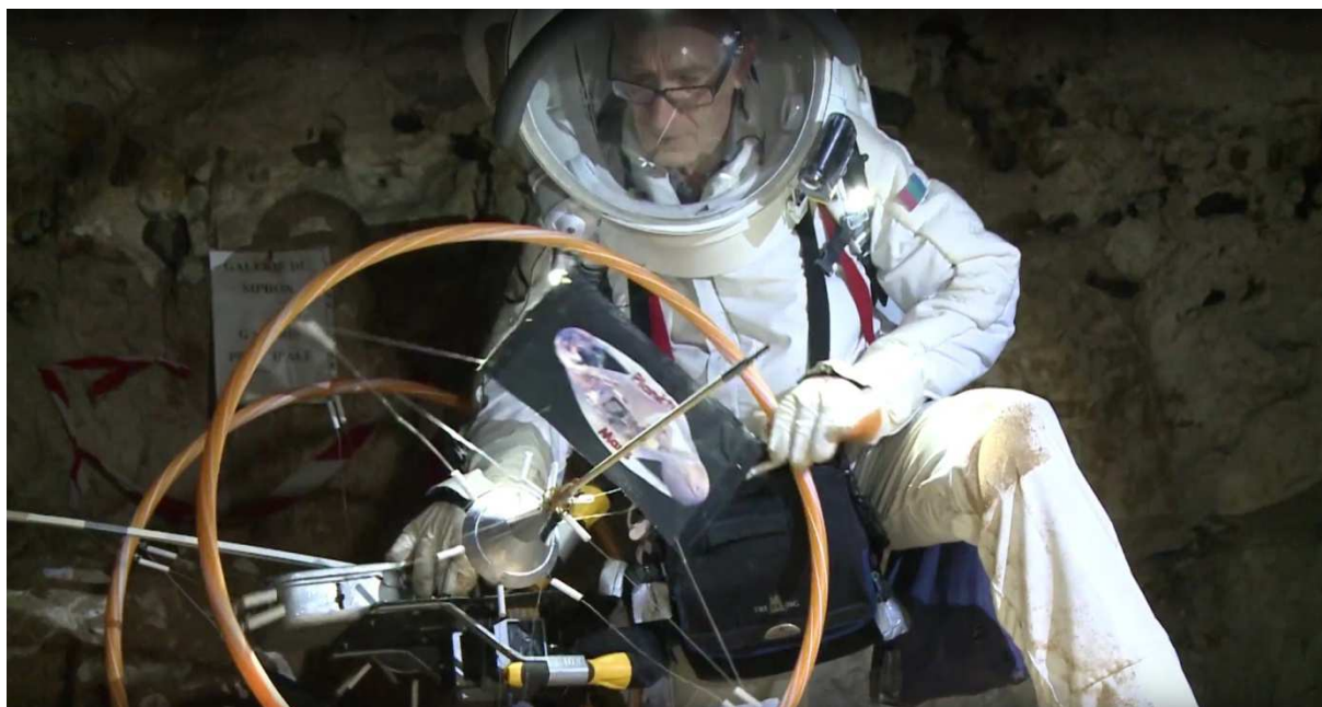
Rotation de la roue pour trouver le trou d'accrochage du crochet de verrouillage de l'anti roulis (doc. J. Barbier/I. Ebran/Gargouille Productions)
