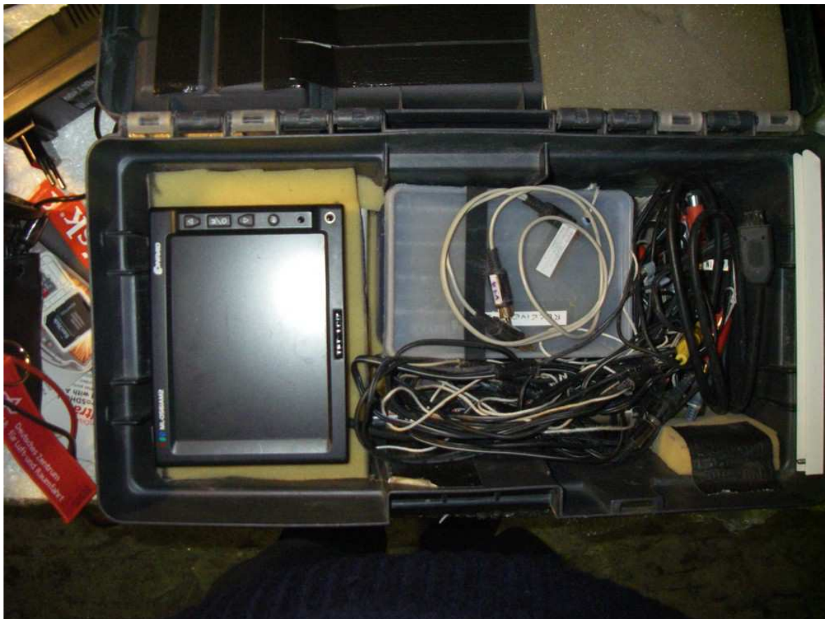
L'intérieur du boîtier réception avec le moniteur à gauche et le récepteur à droite
