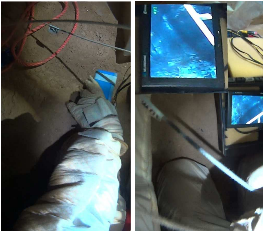
A 150mn 50s, commentaire : « Quand il y a trop de terre devant l'émetteur, on peut perdre le signal ; c'est pour cela que l'émetteur peut être séparé, pardon le récepteur, et envoyé dans la pente en visibilité directe ». Sur l'image de gauche à 150mn 58s, le récepteur bleu est sorti de la boîte de réception. A droite image à 151mn 01s montrant l'approche de la marque 10m et sur l'écran (image redressée sur l'insert) le sol et la roue gauche. (Caméra casque)
