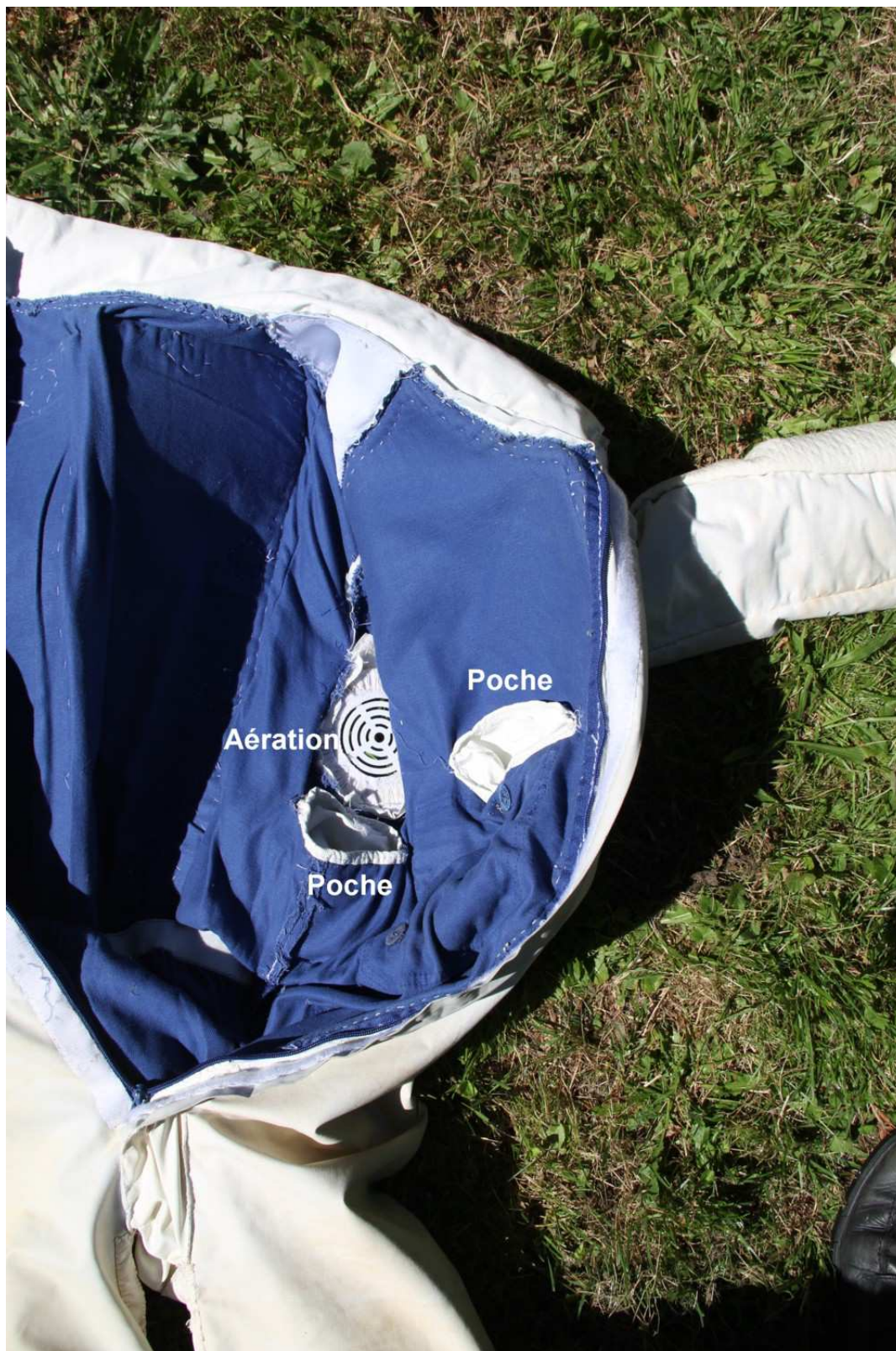
Cette combinaison possède 4 poches internes (2 de chaque côté) qui peuvent être utilisées pour mettre un pack de glace. Cette possibilité a été utilisée lors de l'emploi du scaphandre autour de l'habitat SHEE dans le hall de la Comex en juillet 2015. La vue montre également l'aération coté aisselles.
