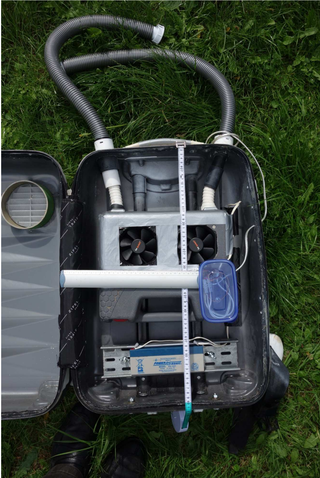
Vue d'ensemble de l'intérieur du back pack 1 avec la batterie en bas et les deux ventilateurs implantés dans une boîte à outil en plastique.
