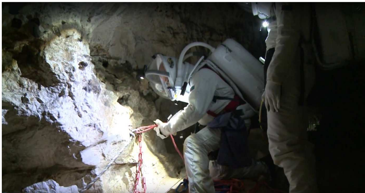
Accrochage de la corde de descente, en bénéficiant d'un anneau existant à 23mn 34s, après avoir fait glisser la corde dans le descendeur pour obtenir une longueur libre suffisante pour faire le nœud. A 24 mn 12s Alain annonce une température interne à 33°C et replace l'afficheur de température sur son attache Velcro car il s'était détaché. (Doc. J. Barbier/I. Ebran/Gargouille Productions)
