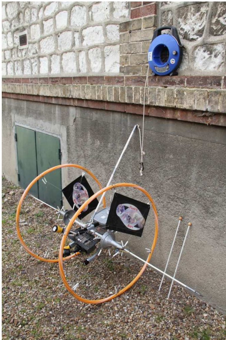
Le VRP en configuration Petite Dales avec deux demi anti roulis (les 2 extrémités étant séparées et appuyées au mur). Le dérouleur contient 36 m de cordelette.
