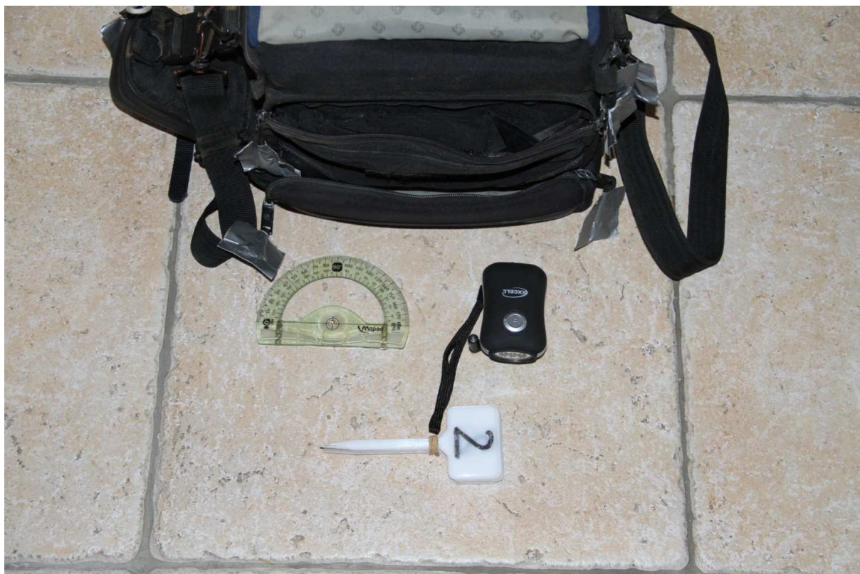
Le contenu de la pochette avant : les étiquettes de marquage, le rapporteur modifié, la lampe de secours à dynamo. Comme lors de précédentes simulation, les fermetures éclairs sont équipées de scotchs (carrés argentés) pour élargir la prise compte tenue de l'utilisation des gants de scaphandre pour ouvrir.
