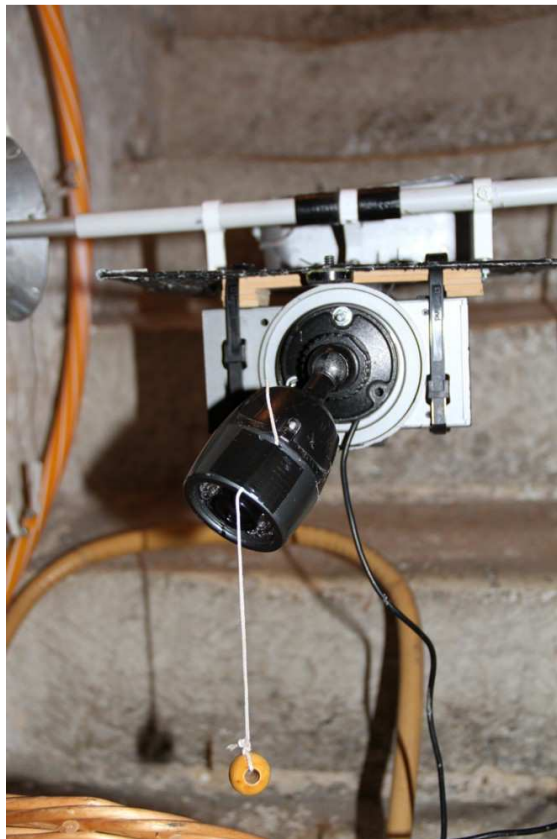
L'ensemble Bescor Hazcam est fixé sur la platine centrale par des T raps avec insertion d'une cale entre le Bescor et la platine
