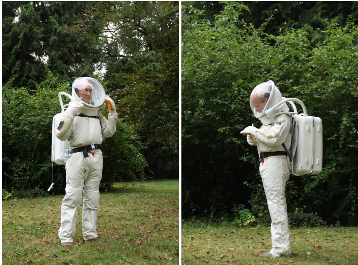
Ensemble scaphandre avec pack dorsal 2. Vue de face et profil. La commande des ventilateurs pend à gauche. Le back pack est constitué d'une valise qui s'ouvre et se ferme avec deux fermetures éclair. Sur l'image de droite on voit le côté charnière de la valise.
