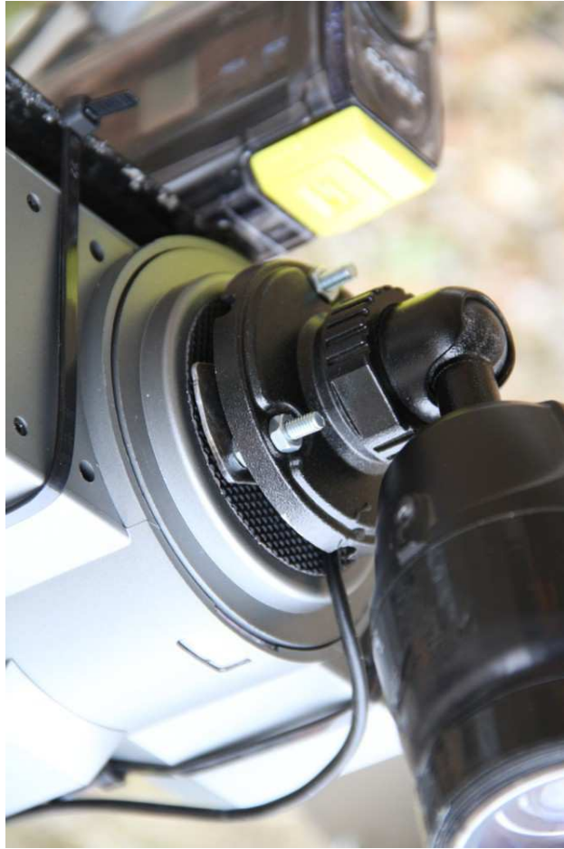
La fixation de la Hazcam Sygonix sur le système de balayage Bescor
