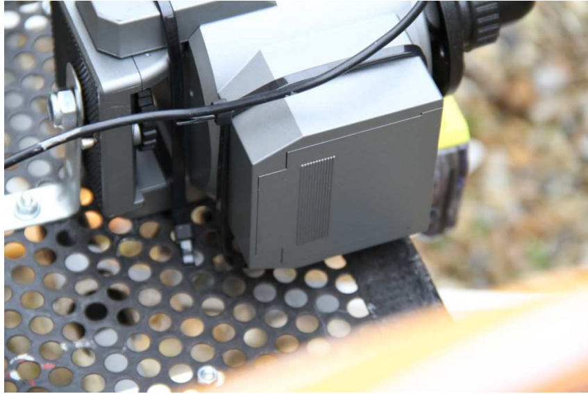
Le Bescor est alimenté par 4 batteries AA accessibles par une trappe
