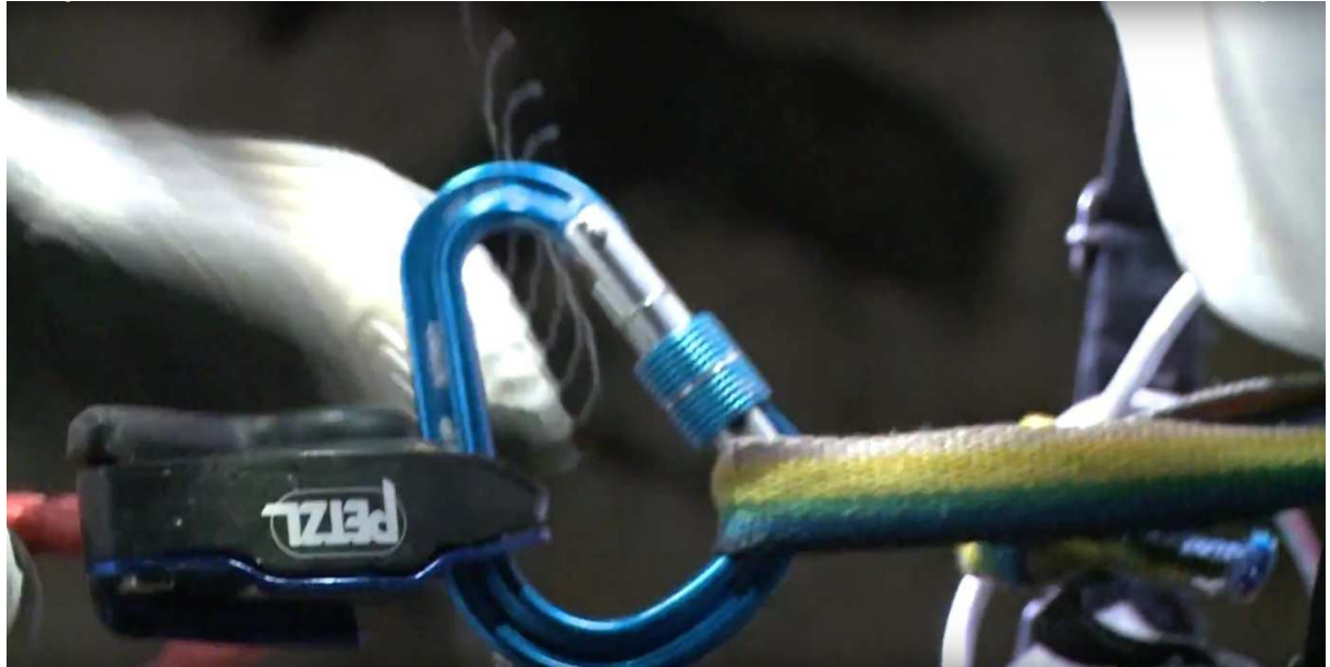
Le mousqueton du descendeur accroché à la boucle courte de sangle elle-même passée dans le mousqueton du harnais avant la simulation (doc. J. Barbier/I. Ebran/Gargouille Productions)
