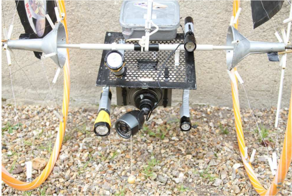
Vue rapprochée de la platine centrale avec au dessus le boîtier du système d'émission vidéo et en dessous le système de balayage angulaire Bescor sur lequel est accrochée la Hazcam Sygonix par l'intermédiaire d'un pied rotulé qui permet son orientation.
