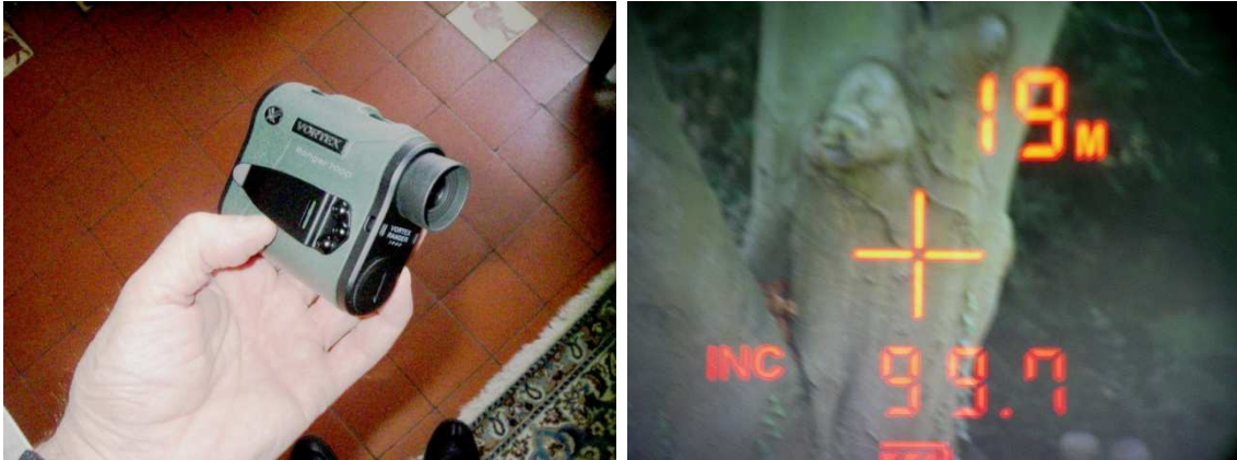
Le télémètre laser Vortex et les indications dans le viseur ; mais ce télémètre ne descend pas en dessous de 9 à 10 m en distance de mesure.
