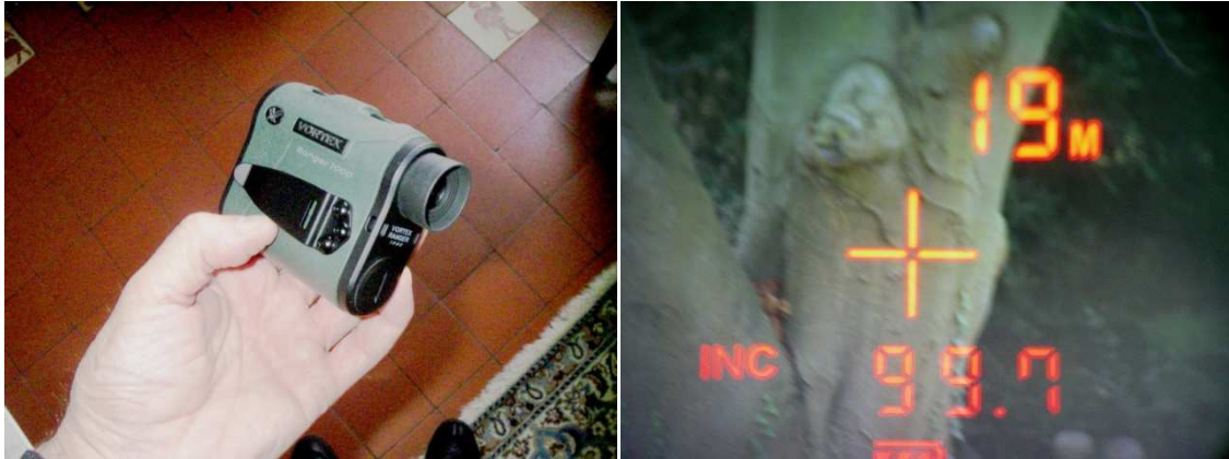
Le télémètre à gauche et ce que l'on voit dans le champ à droite avec une mesure à 19m de distance et une visée quasi horizontale, le cosinus valant 0,997
