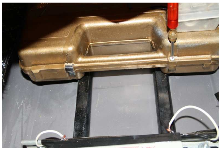
La boîte des ventilateurs s'ouvre en glissant vers la gauche la fermeture à gauche et en dévissant la vis à droite.
