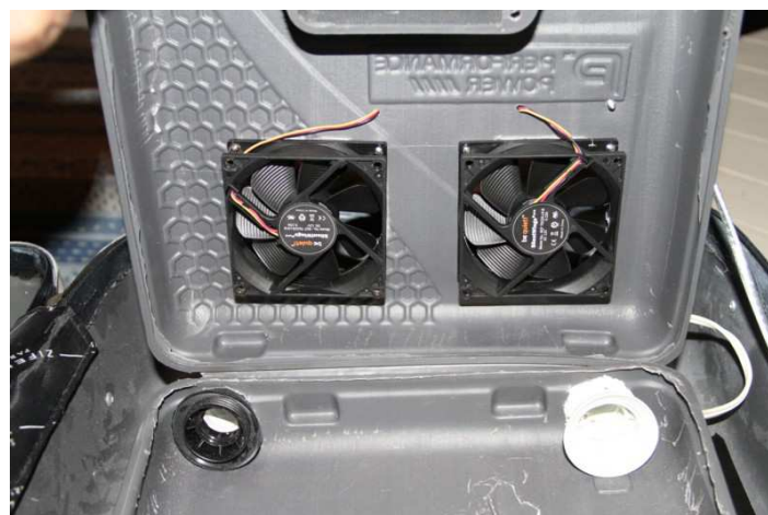
Les deux ventilateurs et les orifices de sortie de l'air de la boîte
