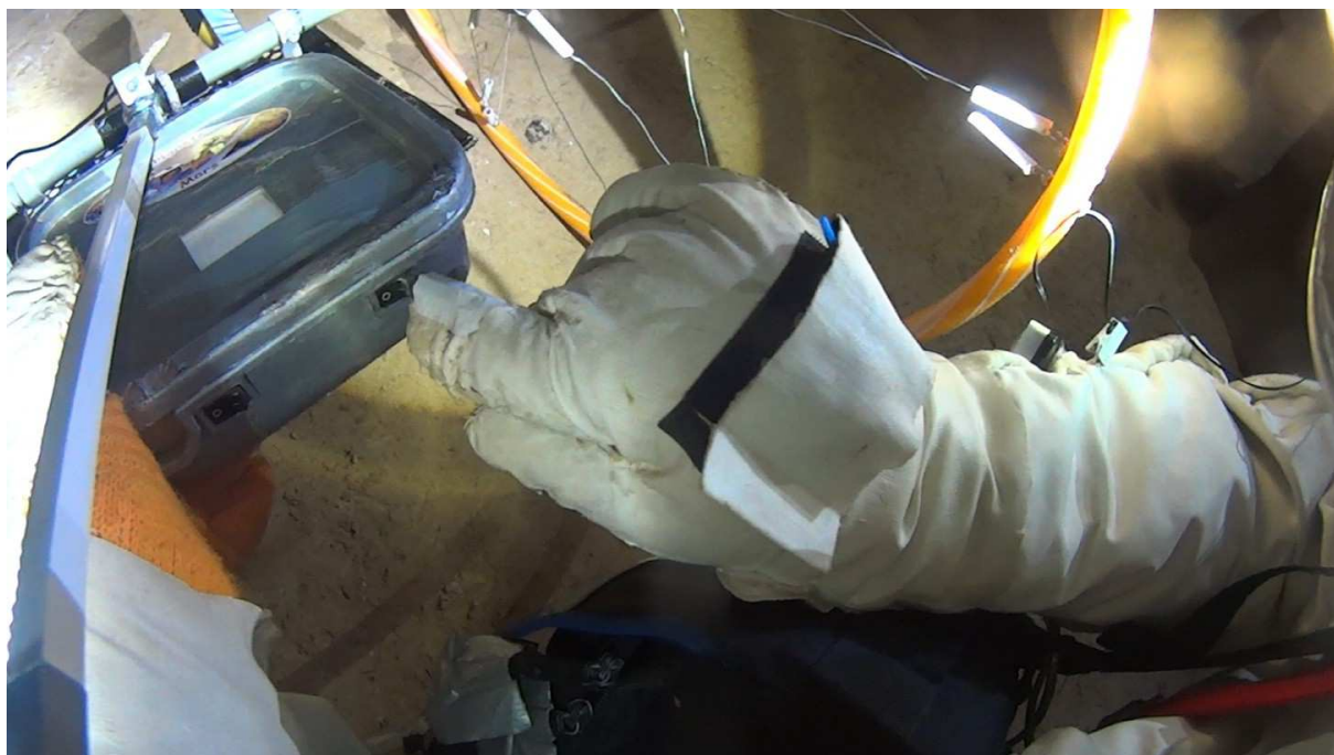
A 12mn 30s actionnement du 1 er bouton du boîtier d'émission vidéo avec le picot RCA du gant droit. A 12mn 33s le 2 ème bouton est actionné de la même manière. (Caméra casque)
