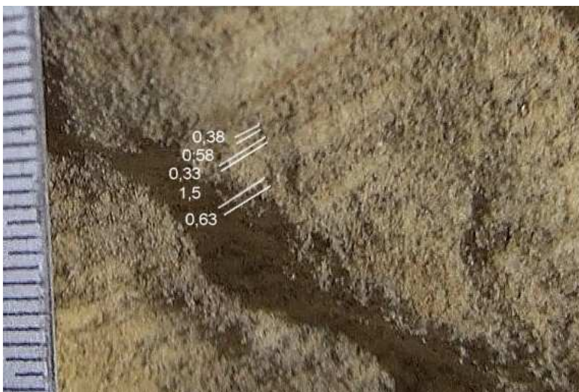
Exemple des mesures d'épaisseurs de strates (en mm) qui peuvent être effectuées sur la vue précédente (caméra Sony GW 55, Alain en sim)
