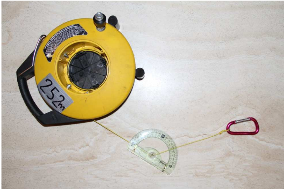
Le dérouleur de fil d'Ariane contenant 252 m de fil et le rapporteur placé dans une configuration expliquant la méthode de mesure d'angle
