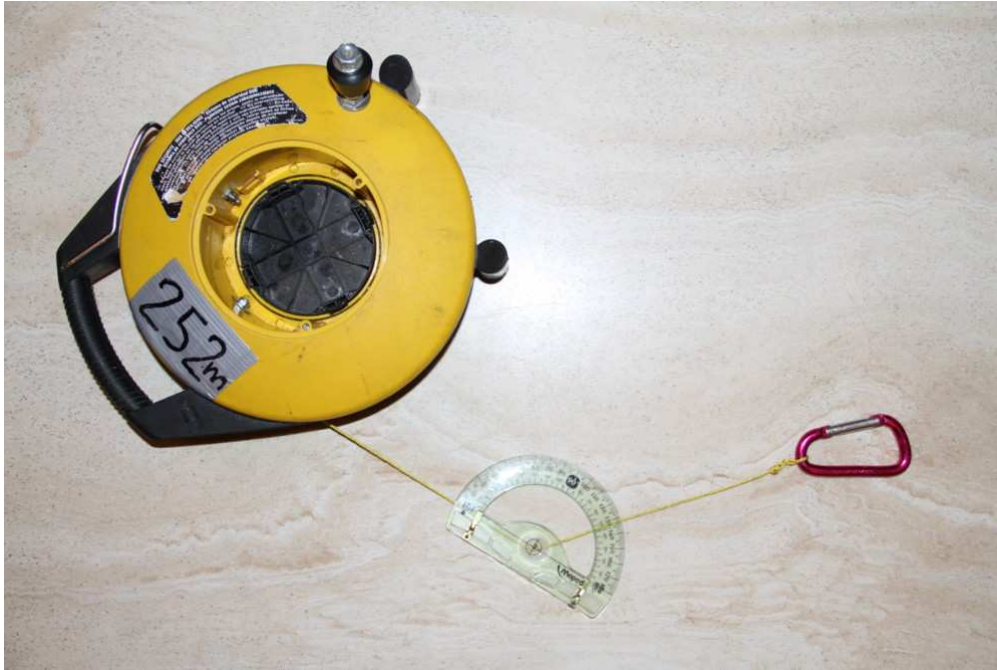
Le dérouleur avec 252 m et le rapporteur modifié pour mesure des angles
