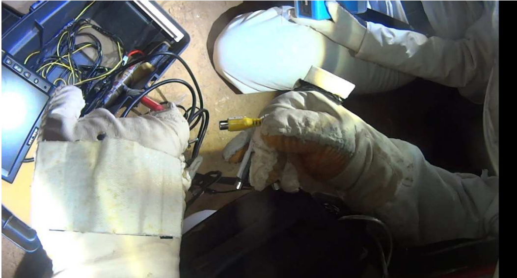
A 14mn 03s connexion de la liaison vidéo récepteur moniteur au 1 er essai (caméra casque)
