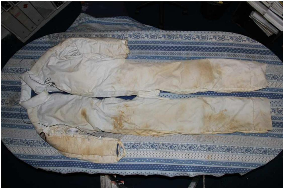
***Combinaison homme coté face (et après la simulation). La fermeture sur le devant est une fermeture éclair avec, par-dessus, une fermeture Velcro. Deux petites lanières à fermeture Velcro sont placées au bout des manches pour serrage sur la partie interne du gant avant refermeture, par-dessus, de la large bande présente sur le gant également à fermeture Velcro.***
