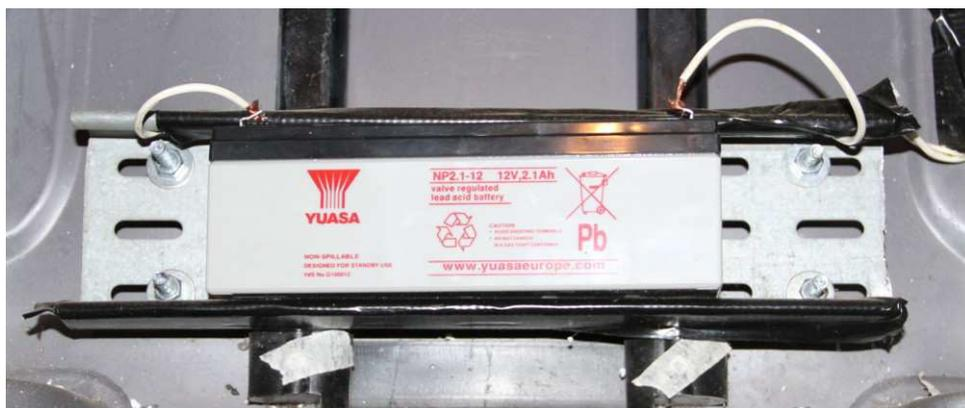
**La batterie YUASA NP2-1-12 12V /2,1 Ah soit 2,5 Ah. A 2,16 W pour les deux ventilateurs, l'autonomie théorique est de 11,6 h.**
