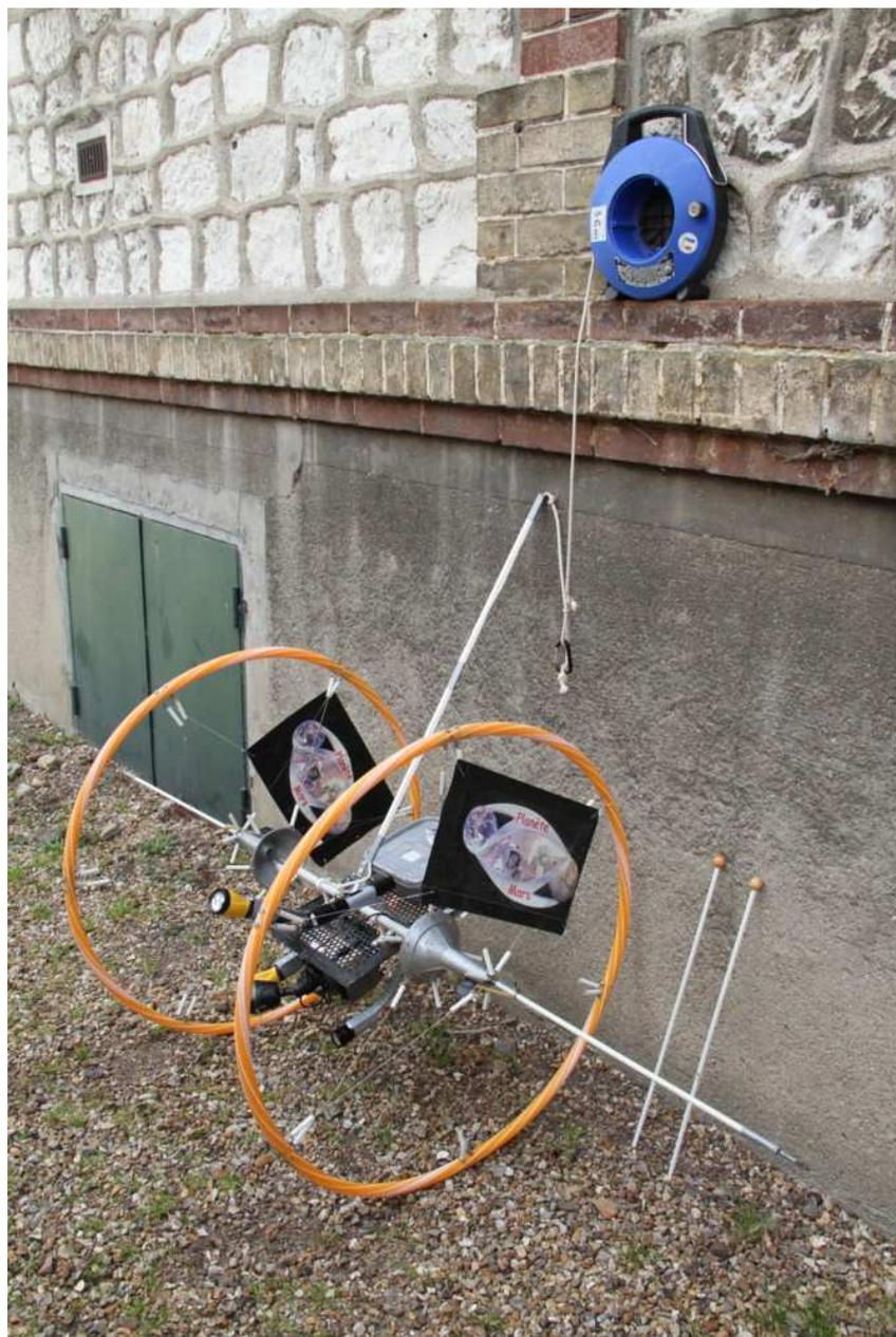
***Le VRP dans la configuration simulation Petites-Dales. Compte tenu de la largeur limitée de la descente de la galerie du siphon, le véhicule n'est équipé que de deux demi anti roulis de 50 cm, et pas de la longueur totale disponible d'un mètre (les deux demi anti roulis extérieurs habituellement utilisés sont contre le mur).***
