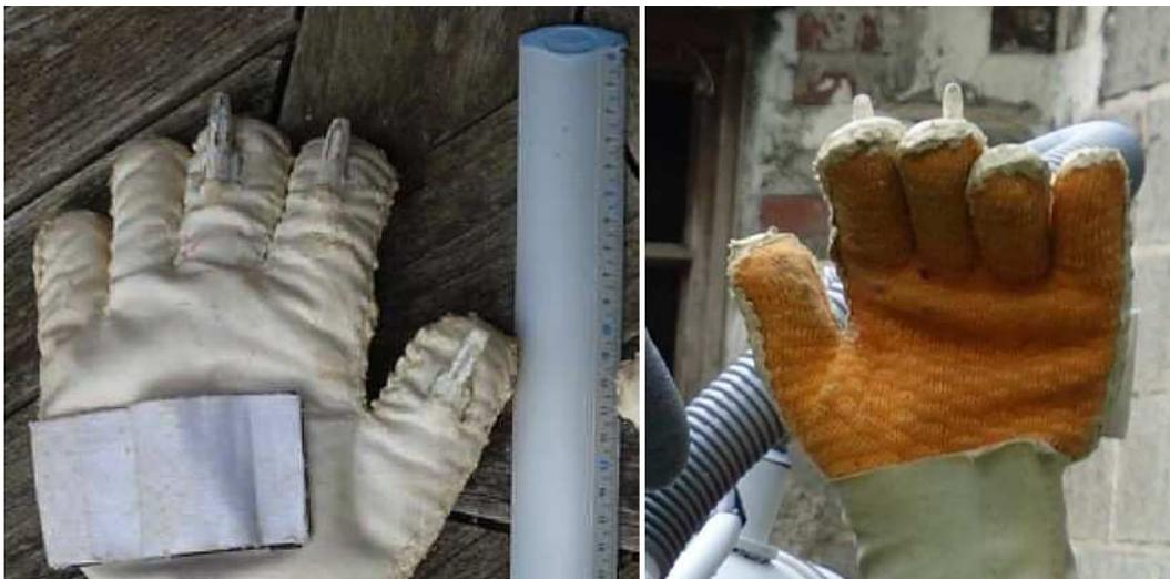
*Vues dos et face du gant gauche avec les picots ou ergots utilisés pour certaines actions lors de la simulation. Les aides à la dextérité qui se fixent sur ces picots (différents sur le gant gauche et le gant droit) n'ont pas eu à être utilisés lors de la simulation.*
