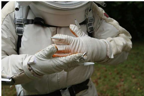
*Sur la manche droite l'afficheur de température. La sonde est au bout d'un fil assez long pour la placer à différents endroits dans l'habit. A droite les gants avec les aides à la dextérité amovibles dans la configuration initiale des gants.*
