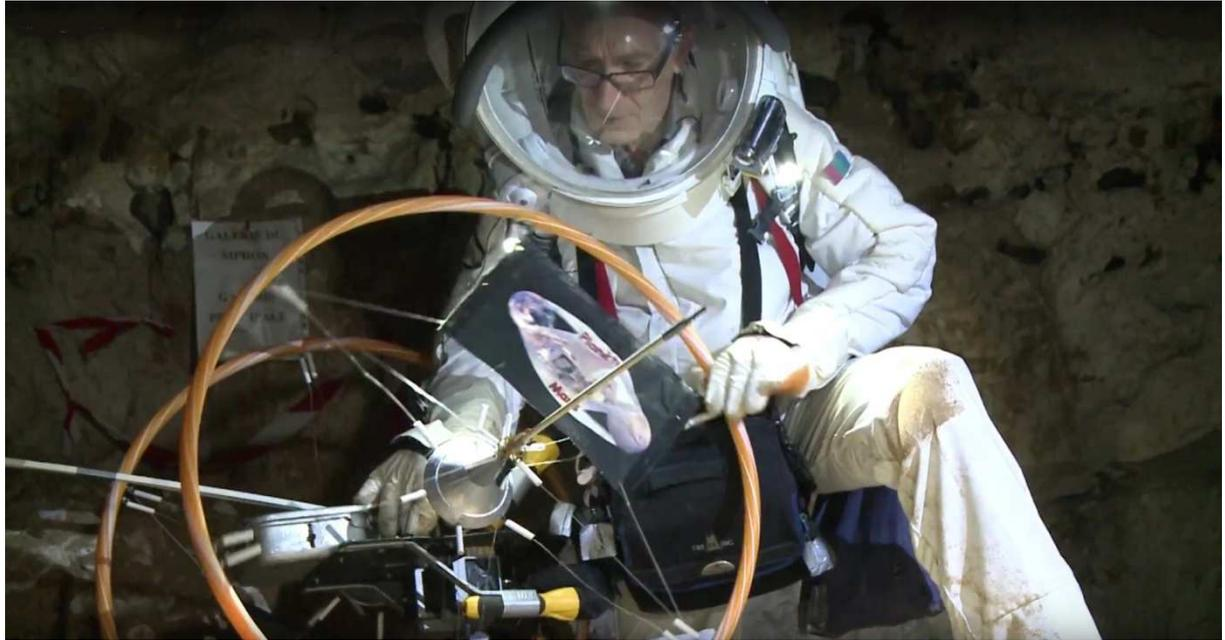
*Rotation de la roue pour trouver le trou d'accrochage du crochet de verrouillage de l'anti roulis
