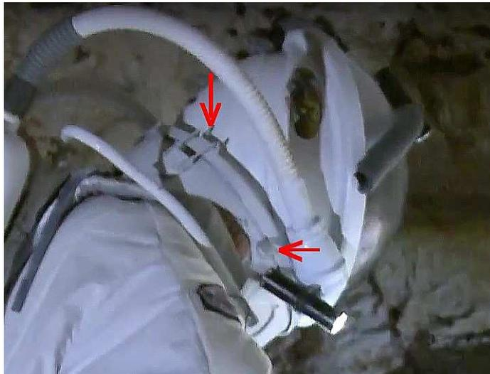
***A droite le collier ouvert qui n'est plus lié au tube en U. Au dessus le crochet arrière droit est bien en place. (Doc. J. Barbier/I. Ebran/Gargouille Productions)***
