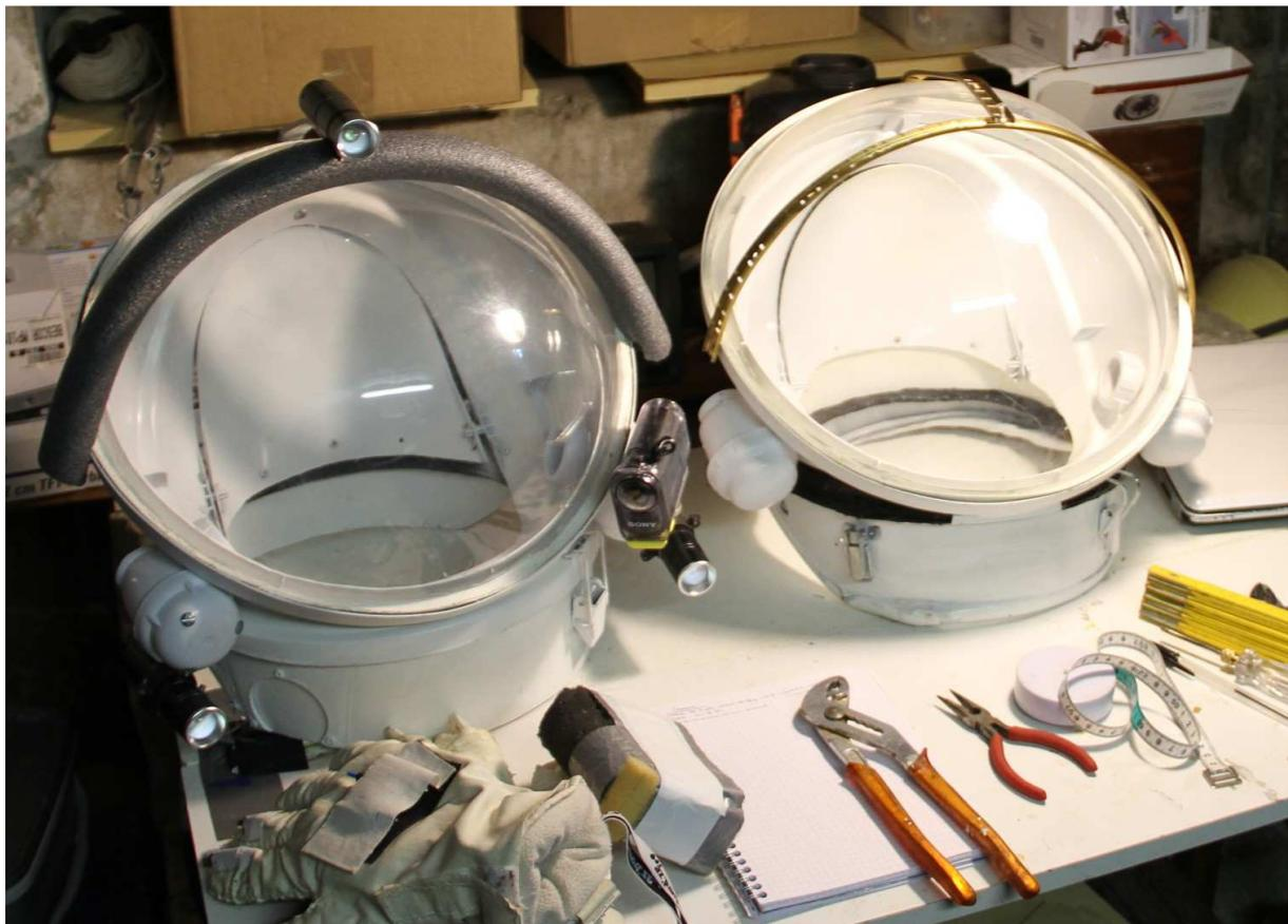
*La structure des arceaux de protection du casque 1 avant mise en place des protections extérieures*
