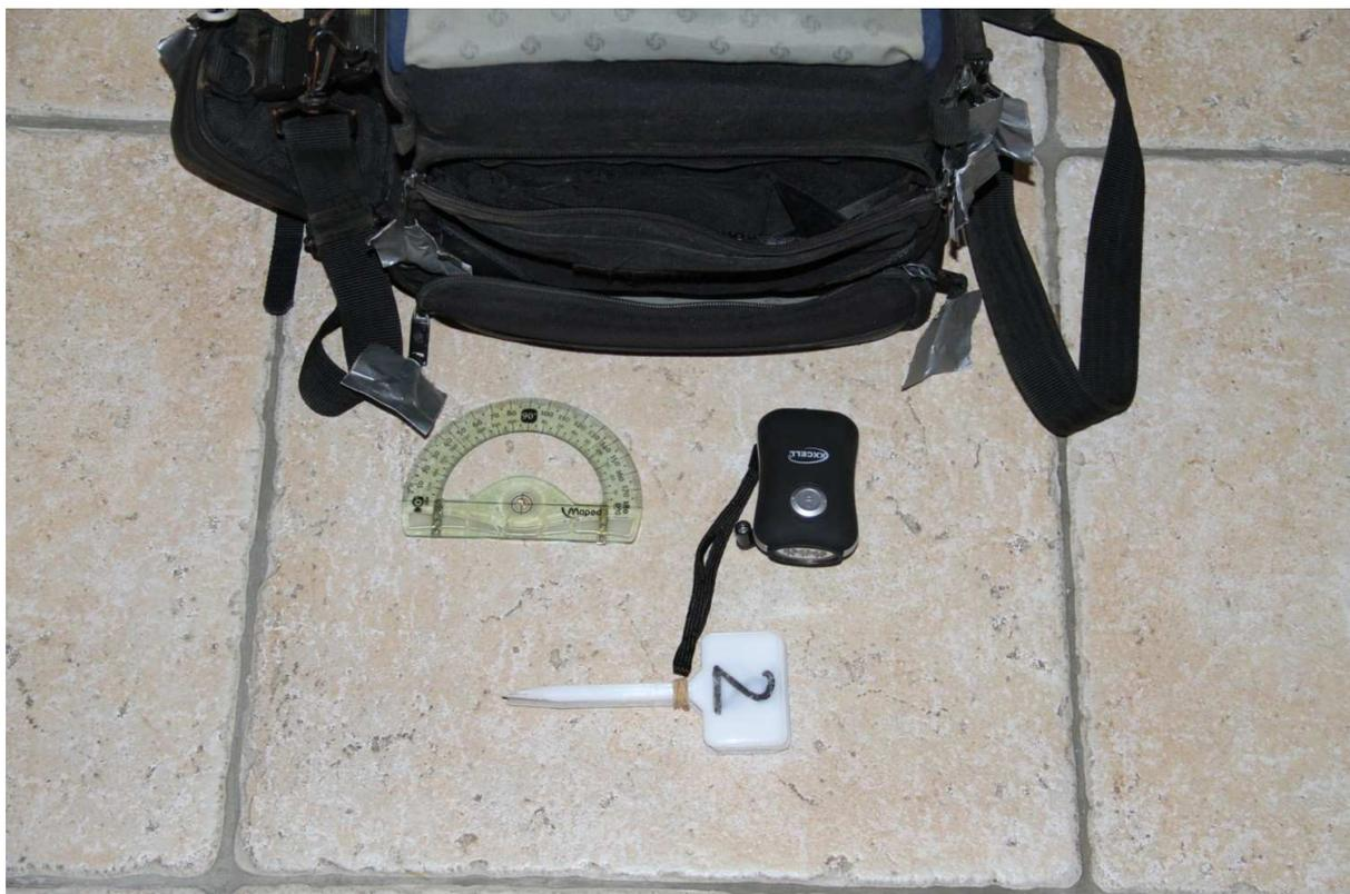
***Le contenu de la pochette avant : les étiquettes de marquage, le rapporteur modifié, la lampe de secours à dynamo. Comme lors de précédentes simulation, les fermetures éclair sont équipées de scotchs (carrés argentés) pour élargir la prise compte tenue de l'utilisation des gants de scaphandre pour ouvrir.***
