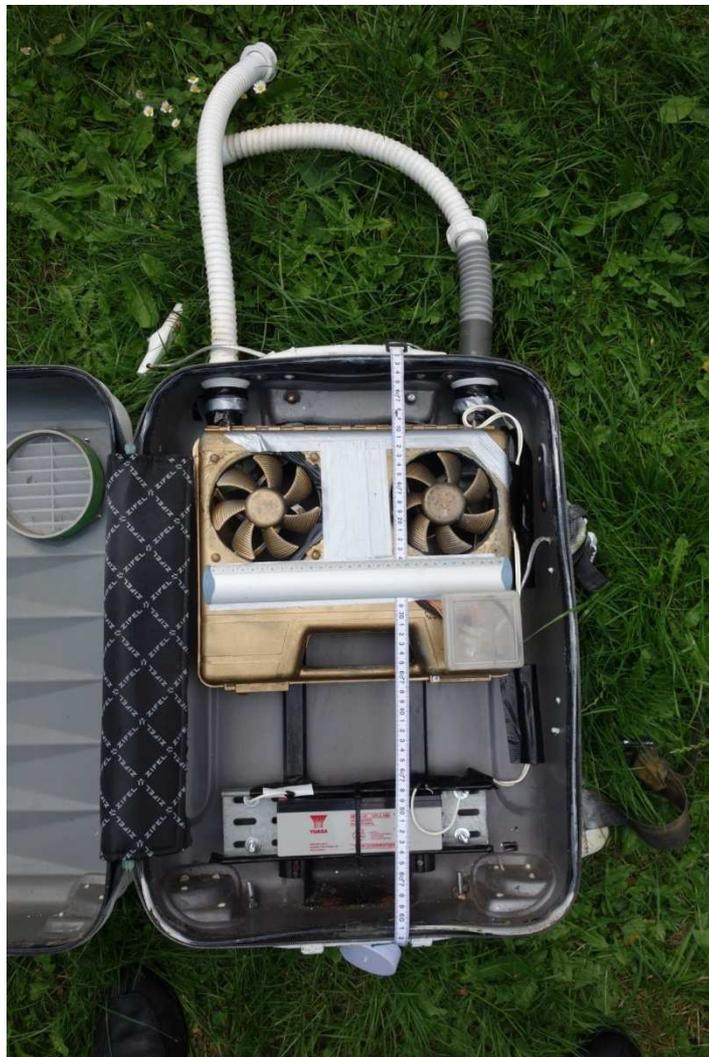
*Vue d'ensemble de l'intérieur du back pack 1 avec la batterie en bas et les deux ventilateurs implantés dans une boîte à outil en plastique. En haut à droite l'un des tubes d'arrivée d'air a été équipé d'un manchon extérieur suite à rupture antérieure du tube annelé blanc au niveau de la sortie du pack.*
