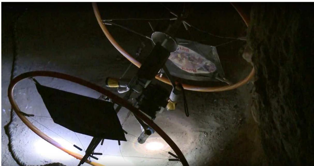
*Le véhicule s'est mis en travers suite à contact de l'anti roulis avec la paroi, à droite sur cette image prise du bas de la pente. Après des manœuvres de traction relâchement de la corde, il se retourne, caméra et lampes visant alors vers le haut. (Doc. J. Barbier/I. Ebran/Gargouille Productions)*
