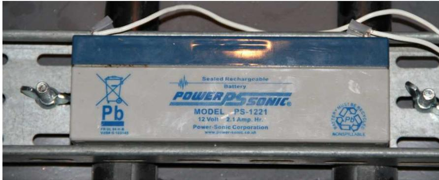
***La batterie Power PS sonic Model PS-1221 12 V/2,1Ah soit 2,5 Wh. A 3,6 W de consommation par les ventilateurs, l'autonomie théorique est de 7 h.***
