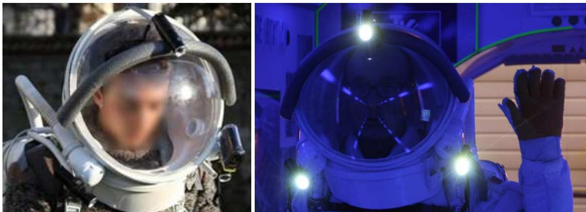
***Les trois lampes fixées sur le casque, avec sur l'image de gauche la caméra Sony HDRAS15 en place du côté épaule gauche et au dessus de l'une des lampes. Il est possible comme lors de la simulation précédente aux falaises des Vaches Noires que les équipes de tournage ajoutent des caméras type Go Pro sur les casques.***
