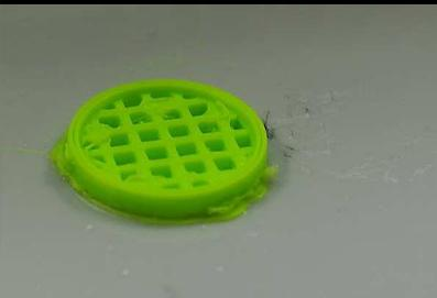
Réalisation, en dépannage d'une pièce opérationnelle en impression 3 D (filtre de pompe à eau)
