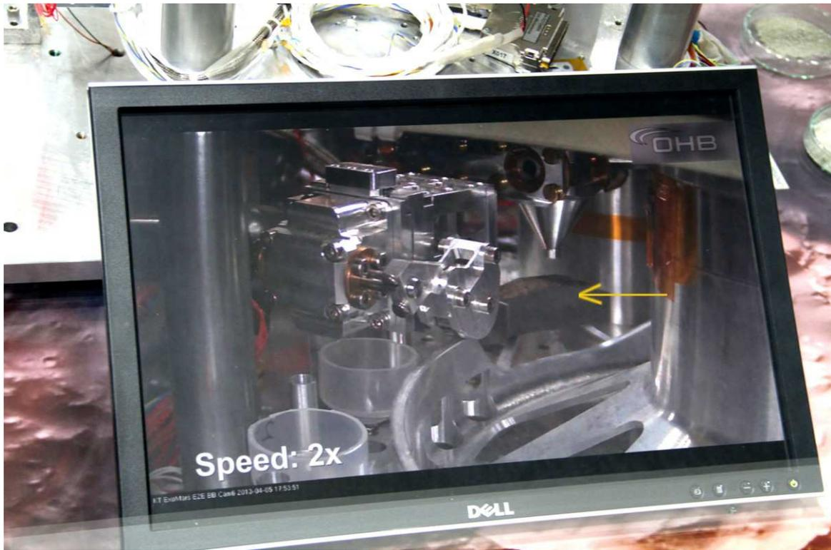
***Le PSDDS peut alimenter ensuite un coupelle sous l'entonnoir à droite de l'écran (flèche jaune) où la poudre va être tassée. Cette coupelle est située sur la roue PSHS qui comporte par ailleurs des fours à pyrolyse.***
