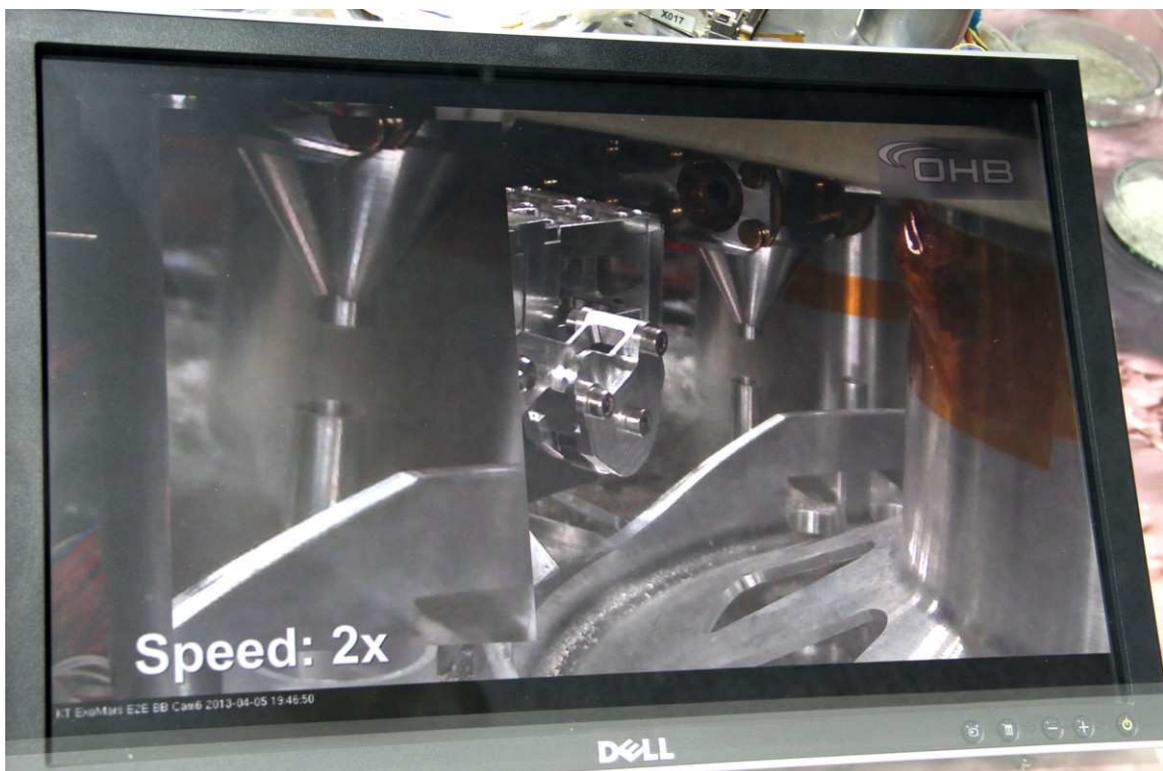
*Mais le PSDDS peut alimenter directement les tubes fours à pyrolyse qui se trouvent sur la roue carousel PSHS.*
