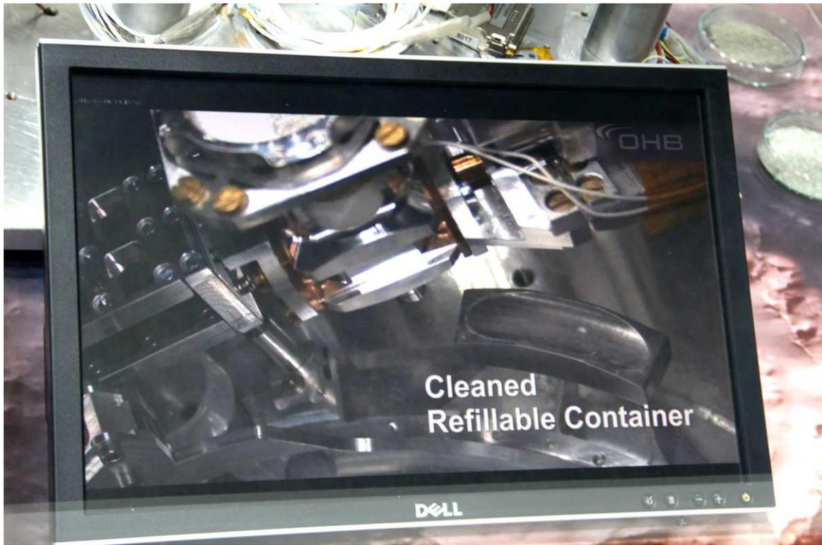
*Quand l'analyse est terminée la coupelle est vidée et nettoyée par le CB en prévision d'une nouvelle utilisation.*
