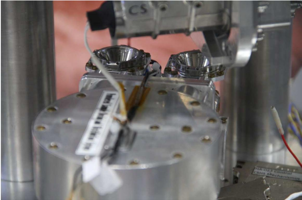
*Le PSDDS est alimenté à partir du broyeur CS par ces deux entonnoirs d'entrée.*
