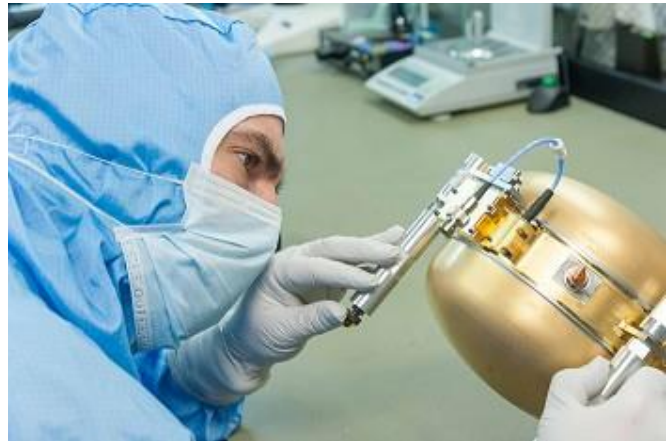
La sphère en titane contenant le sismomètre SEIS © IPGP/SODERN/CNES/Piraud)
