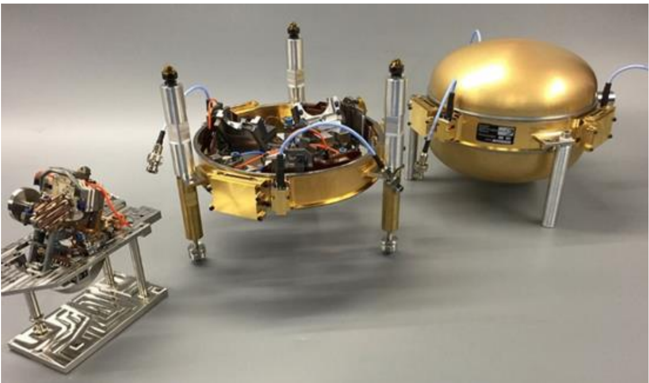
Les composants du sismomètre SEIS : de gauche à droite: un des capteurs très large bande (VLB), le berceau permettant de compenser les irrégularités du terrain et la sphère contenant les capteurs VLB. Crédits : IPGP/SODERN/CNES/Piraud)
