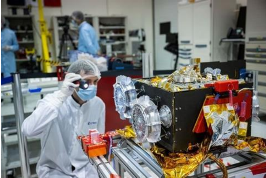
IDEFIX et ses roues à aubes en cours de fabrication au CNES à Toulouse. © Frédéric Lancelot/ CNES
