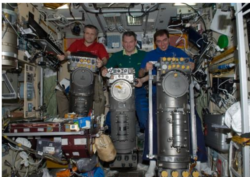
Générateurs d'oxygène russes Elektron dans le module de service Zvezda de la Station spatiale internationale. Source: NASA.
